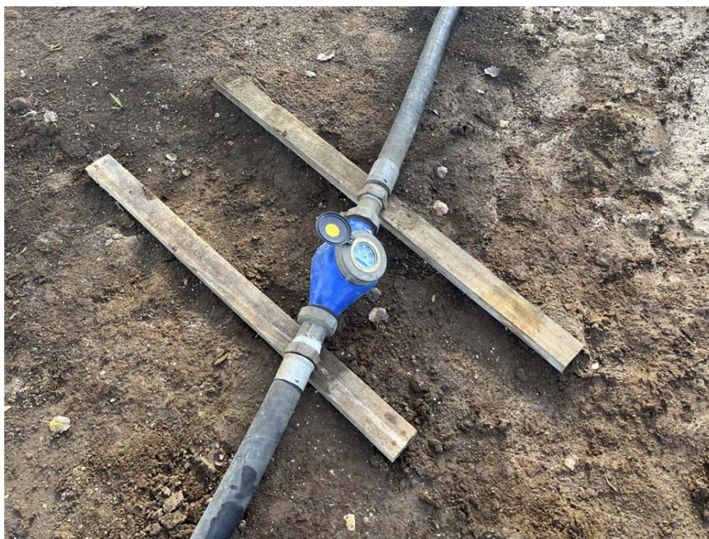
Contaltri indicante la portata istantanea in base alla velocità di rotazione di un mulinello
